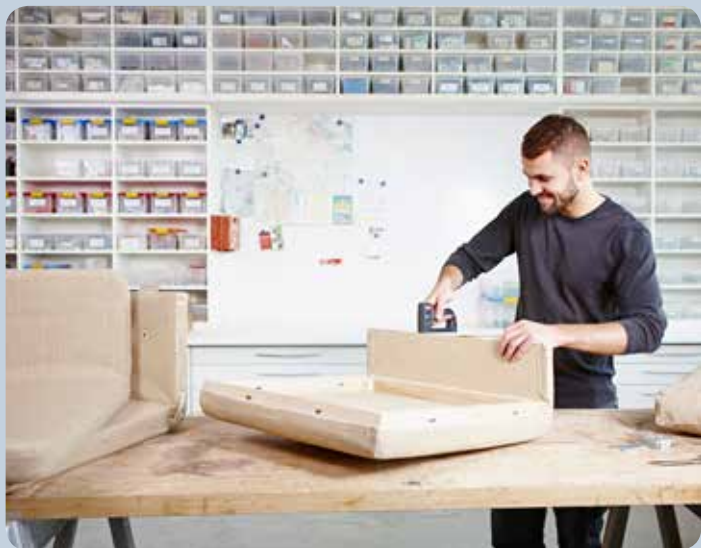
Réaliser tout simplement des travaux de capitonnage avec l'agrafeuse.
