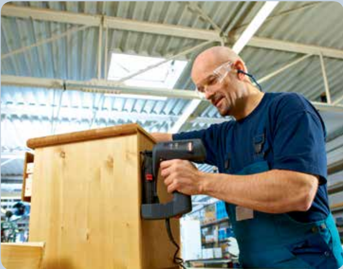
Clouage rapide par ex. des parois arrière de meubles avec l'agrafeuse.
